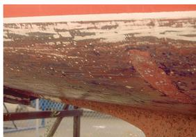
È quando si lascia l'acqua che si dovrebbe osservare le condizioni della superficie della barca. Se sono presenti bolle, rimuovere l'antivegetativa e tutti i rivestimenti sul gelcoat per assicurarsi che siano in poliestere. Forando queste bolle, generalmente vediamo la presenza di un liquido acido con il caratteristico odore di aceto.
