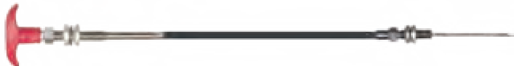
XLMRSC-LENGTH (Arresto acceleratore/carburante) Lunghezza libera: 175mm | Guaina: 7.0mm | Interno: 1.5 mm Filo solido acciaio
