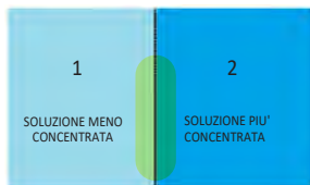
membrana semi-permeabile (permeabile al solvente, impermeabile alla soluzione)
