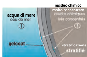
La presenza di acqua di mare da un lato (1) e residui di idrolisi dall'altro (2) attiveranno l'osmosi.
