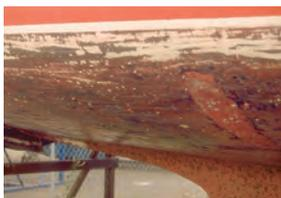
È quando si lascia l'acqua che si dovrebbe osservare le condizioni della superficie della barca. Se sono presenti bolle, rimuovere l'antivegetativa e tutti i rivestimenti sul gelcoat per assicurarsi che siano nel poliestere. Forando queste bolle, generalmente vediamo la presenza di un liquido acido con il caratteristico odore di aceto.
