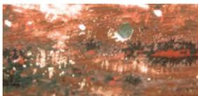
Sugli scafi vecchi il cui gelcoat è poroso, le bolle non si formano sempre, ma l'idrolisi è molto reale. Una misurazione con il tester evidenzierà il livello di umidità. L'eliminazione del gelcoat ci consentirà di aggiornare eventuali degradazioni.
