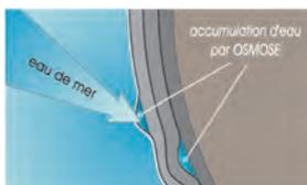
> Al fine di bilanciare la concentrazione, l'acqua di mare penetrerà sempre più attraverso il gelcoat, che funge da membrana semipermeabile. C'è una maggiore pressione sotto il gelcoat e le vesciche.
