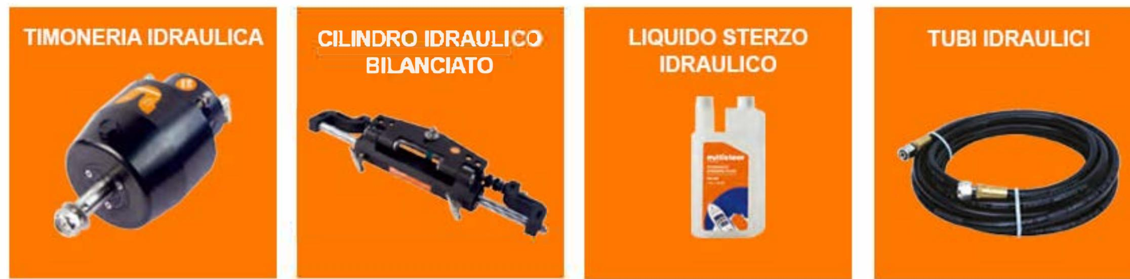
**POMPA TIMONERIA IDRAULICA:** si tratta di una pompa azionata a pistoni assiali che aspira e spinge il flusso del fluido di sterzo quando viene ruotata la ruota montata sull'albero del timone. Una valvola di blocco e una valvola limitatrice di pressione proteggono il sistema da feedback e pressioni insolite.
