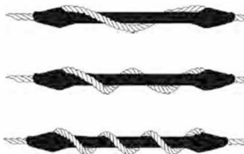
L'estensione del compensatore può essere variata cambiando il numero di volte che la linea viene avvolta attorno ad esso. Più giri, più si può estendere ulteriormente il compensatore. Si può impostare l'estensione desiderata. In luoghi stretti di ormeggio, es. tra i bracci, uno o due giri sono sufficienti.
